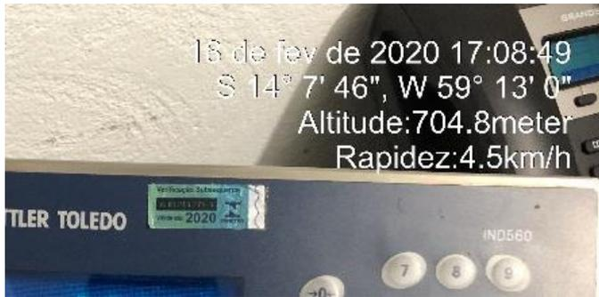
32 Selo de calibração Inmetro da Balança de pesagem
